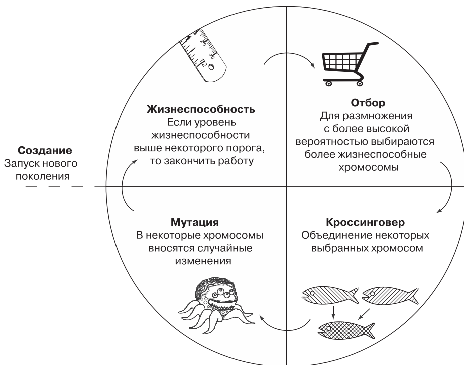
Рис. 5.1. Обобщенная схема генетического алгоритма
